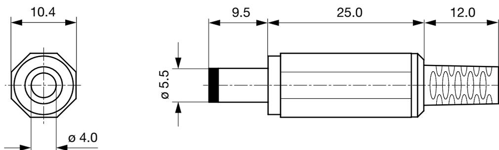
Kabeldurchmesser max. 4.0 mm
